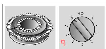
Външен и вътрешен пламък на максимална мощност.
