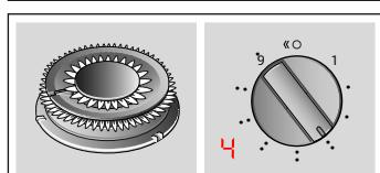
Външен пламък на минимална, вътрешен пламък на максимална мощност.
